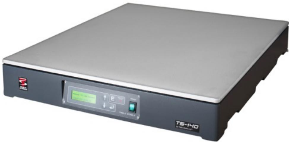
技术指标：频率负载范围尺寸0,7-1000Hz0-140公斤500x600x84毫米隔离：动态（超过1kHz）透射率：参见附件曲线10Hz以上的透射率<-40dB矫正面：垂直+/-8N水平+/-4N静态合规性：大约垂直约12μm/N水平30-40μm/N最大负载：140公斤尺寸500x600x84毫米重量28.5kg电的安全等级：1个能量消耗：最大10W负载调整时20W输入电压115-230VAC+/-10%50-60Hz超载：显示屏指示负载过重或严重失衡监控信号：示波器上显示的多路复用信号显示有无隔离的振动水平-瑾用于诊断目的前面板显示菜单：显示仪器状态，包括：-高度调节-隔离开/关-过载-运输锁定-技术热线桌上尺寸500x600毫米。湖北中芯国际隔振台首次使用AVI系统时，将前面板隔离开关设置为关闭（黑色旋钮熄灭）。
