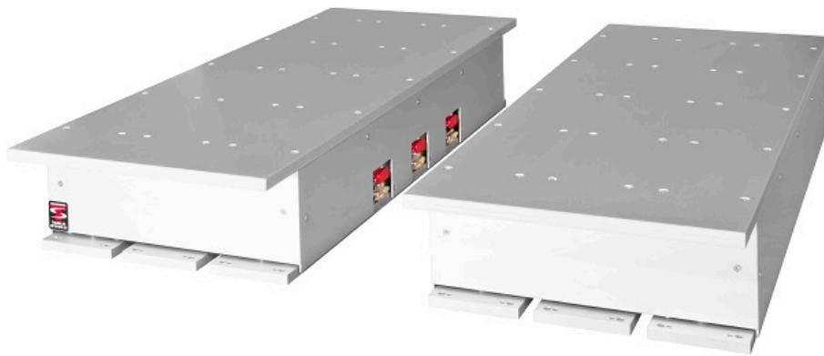
AVI400-SAVI400-S的基本配置包括两个紧凑型单元和一个控制单元，最大负载为800公斤。通过增加紧凑型模块的数量，可以轻松实现对更高负载的支持。为了使AVI400-S适应用户特定的应用，可以使用不同长度的紧凑型装置AVI400-S的隔离始于1,2Hz超过10HZ以上迅速增加至35db减少低频谐振可得到比普通的被动空气阻尼系统更好的性能AVI400-S系统固有的刚性赋予其出色
